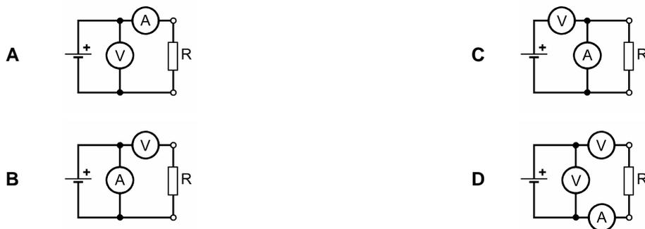
**TJ202** Wie werden elektrische Spannungsmesser an Messobjekte angeschlossen und welche Anforderungen muss das Messgerät erfüllen, damit der Messfehler möglichst gering bleibt?
